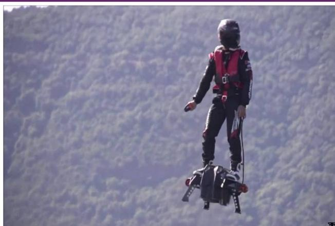
L'appareil embarque 4 moteurs à turbines d'une puissance individuelle de 250 chevaux. Ils sont alimentés par du carburant Jet A1 stocké dans un réservoir placé dans le sac à dos.
